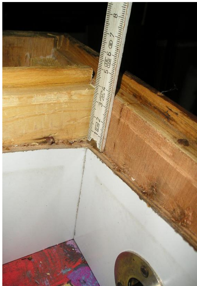
Abbildung 3: Eindrücktiefe der Ecke 3,8 cm, abzgl. 10mm fehlender Leiste
